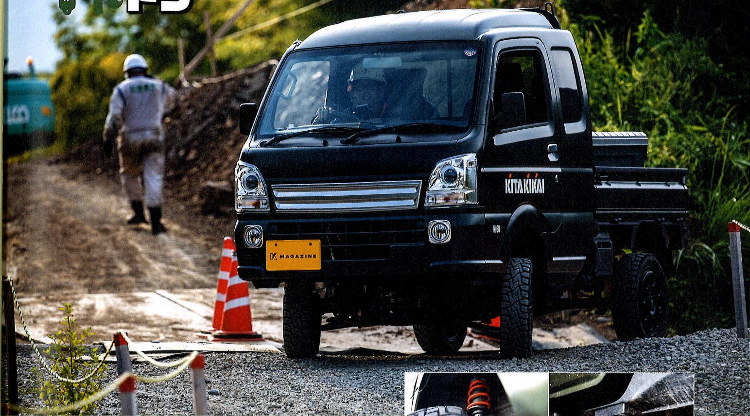
足回りはアウトクラス謹製のオリジナル5インチリフトアップキットを使用。フロントは専用の強化ロングショック＆ロングコイル、リアはアルミブロックやスタビラケットなど専用パーツを多数使ってリフトアップし、ジムニーばりの走破性を実現！ 同社が扱うスズキコンプリート車にも使用するキットなので信頼性はバツグンだ
