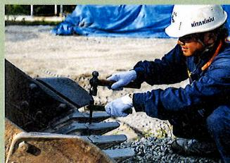
2人の主な仕事はレンタル機材の整備。依頼があればすぐに現場へ行って即対応。大型のショベルカーも扱え、エンジン整備はもちろんアーム調整やバケットのツメ交換、キャタピラの交換など、ほとんどすべての整備を行うプロフェッショナルだ！
